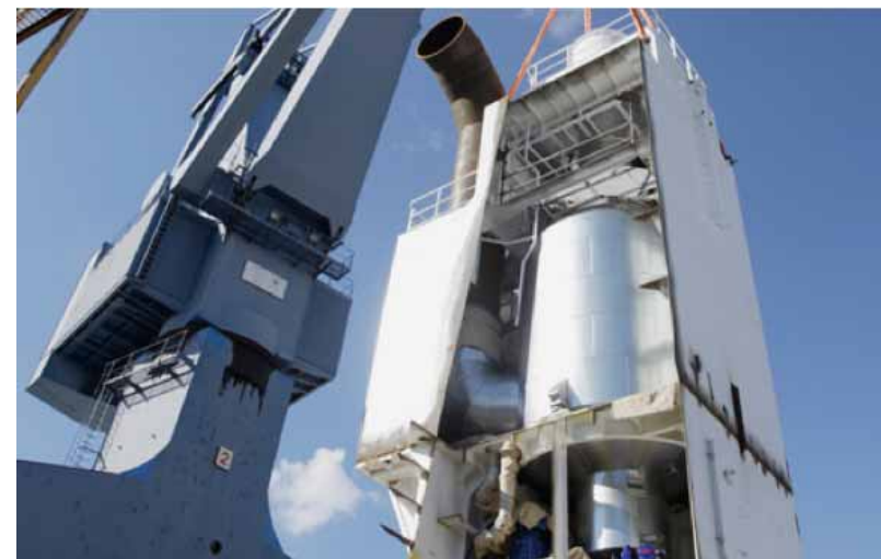
Wärtsilällä on paljon kokemusta voimalaitoksiin toimitetuista rikkipesureista on kattava. Nyt vastaavia ratkaisuja tarjotaan myös laivoihin.
