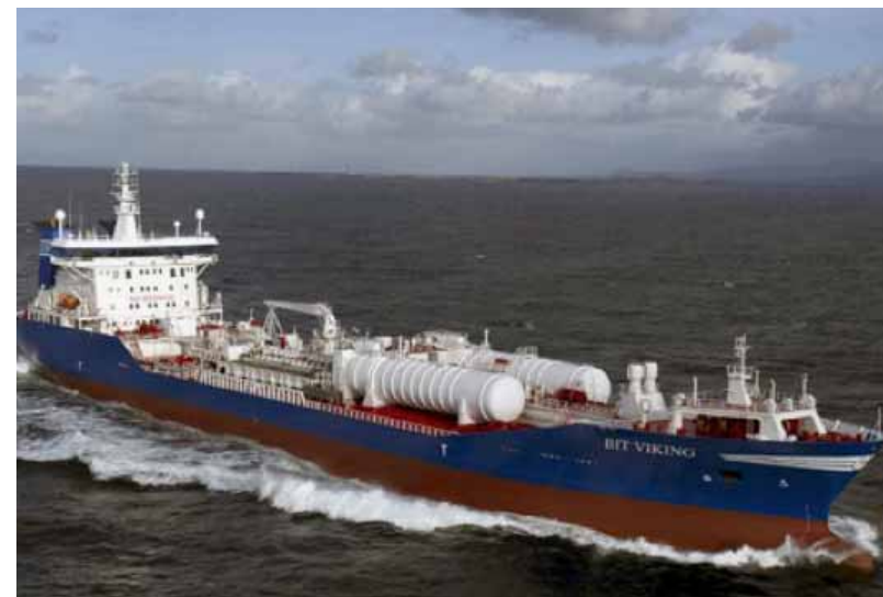
Bit Vikingillä hyödynnetään sekä Wärtsilän DF-monipolttoainemoottoria että uutta LNGPac-järjestelmää, joka mahdollistaa LNG:n turvallisen ja kätevän säilytyksen aluksella.
