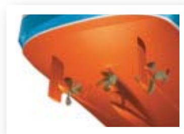
Propulsiojärjestely, jossa integroitu kölipotkuri.
