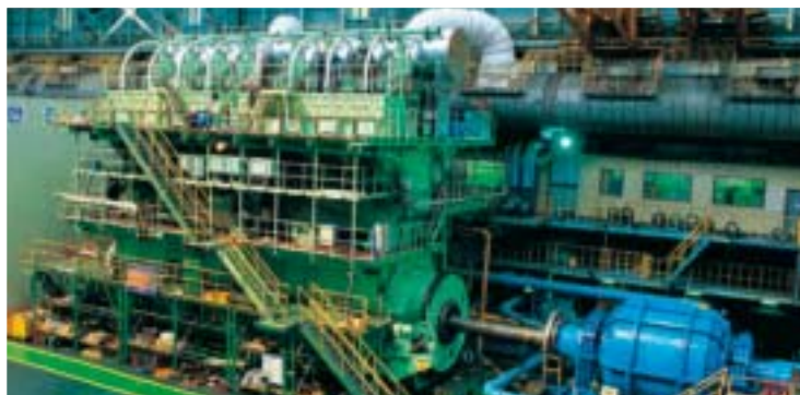
Ensimmäinen Delta Tuning -säätötekniikkaa hyödyntävä moottori on tämä 45.760 kW:n Sulzer 8RT-flex96C. Kuvassa moottoria rakennetaan Koreassa HSD Engine Co Ltd:lle.
